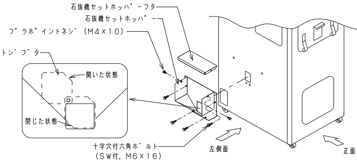
上図のように石抜機セットホッパーを本機左側面に十字穴付六角ボルト(M6×16 SW付)にて4ヶ所止めて下さい。
