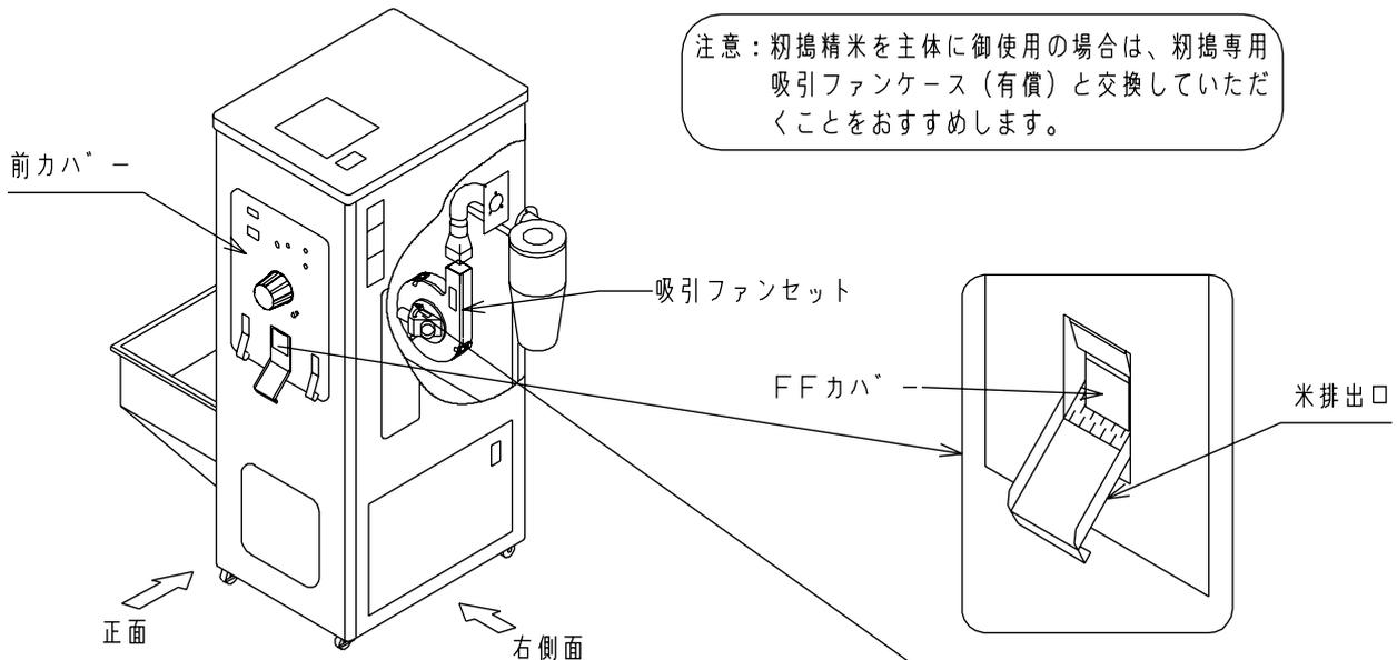
本機には粳精白時に粳殻・ワラクス等を除去するために、フロートフィルター(粳殻・ワラクス吸引)装置が設けてあります。
