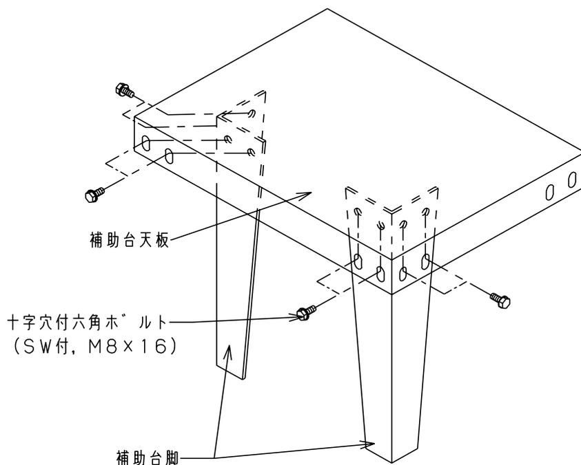
◎左図のように補助台天板に補助脚を十字穴付六角ボルト(M8×16 SW付)にて8ヶ所止めて下さい。
