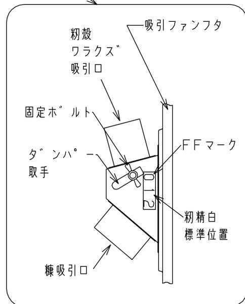
**【注意】** 米排出口が開いた状態で前カバーを閉めると、FFカバーが破損する場合があります。必ず米排出口がしっかり閉まっていることを確認してから、前カバーを閉めて下さい。
