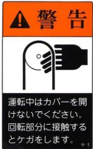
ラベルが貼ってあるカバー(トビラ)を開けると内部に可動部があり、これらを手で直接触ることができます。運転中にこれらに接触しますとケガをしますので、カバー(トビラ)を開く場合は必ず電源プラグを抜いて下さい。
