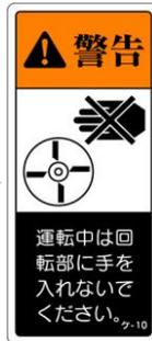
図示の吸引ファンセット内にはファンが収納されております。運転中にこれに接触しますと大ケガをします。運転する場合は必ず吸引ファンフタを閉めて下さい。又、点検・修理などでフタを開ける場合は必ず電源プラグをコンセントから抜いて下さい。
