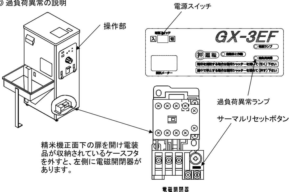
※ 白度の上げ過ぎ・精米機内・揚上スクリュー装置への異物混入ベルトの緩みなどにより本機が過負荷状態になったとき、過負荷異常ランプが点灯して運転が停止します。
