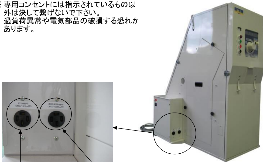
単独昇降機・石抜機コンセント (三相200v-0.1kw)
